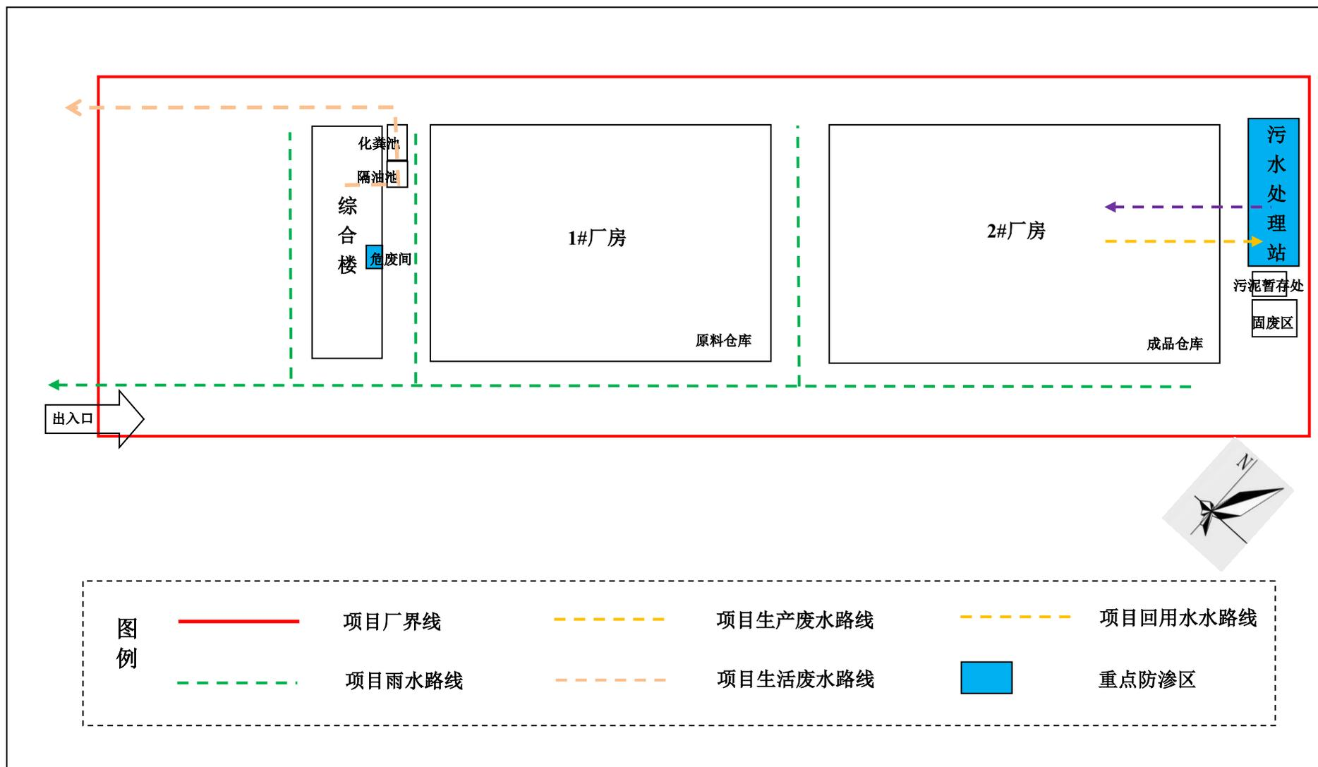
附图3 项目平面布置图及雨污管网图
