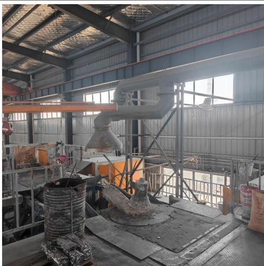
熔炼废气集气罩
