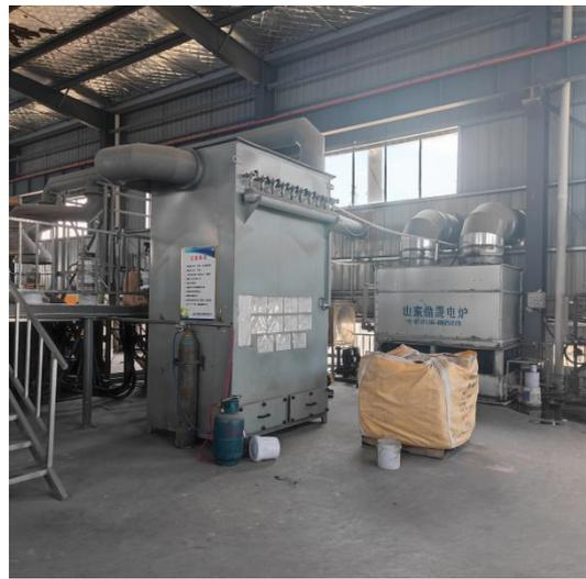
熔炼废气布袋除尘器
