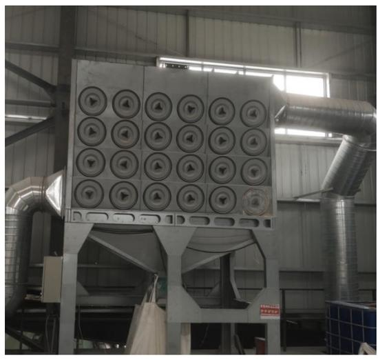
滤筒除尘器（2#车间投料、输送工序）
