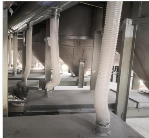
投料、输送工序密闭（1#车间大板生产线）
