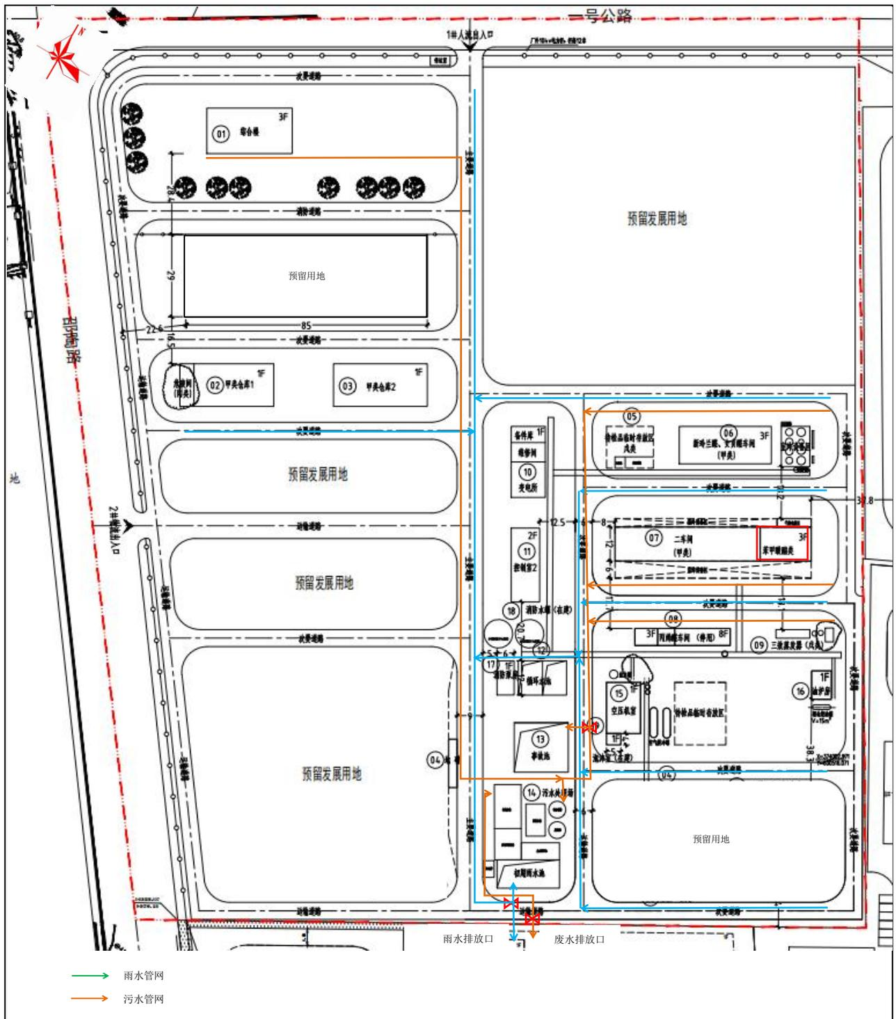
附图4 项目厂区雨污管网图
