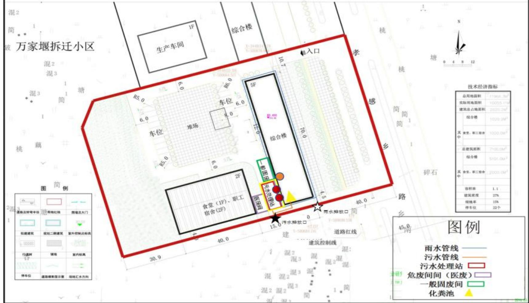
附图3 项目总平面示意图及雨污管网图
