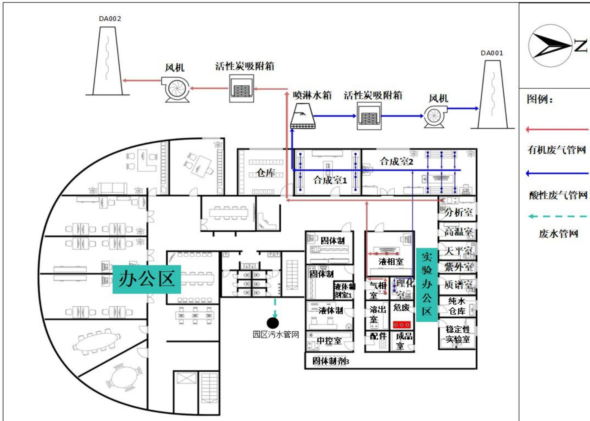
附图 4 项目废气走向和废水走向管网图
