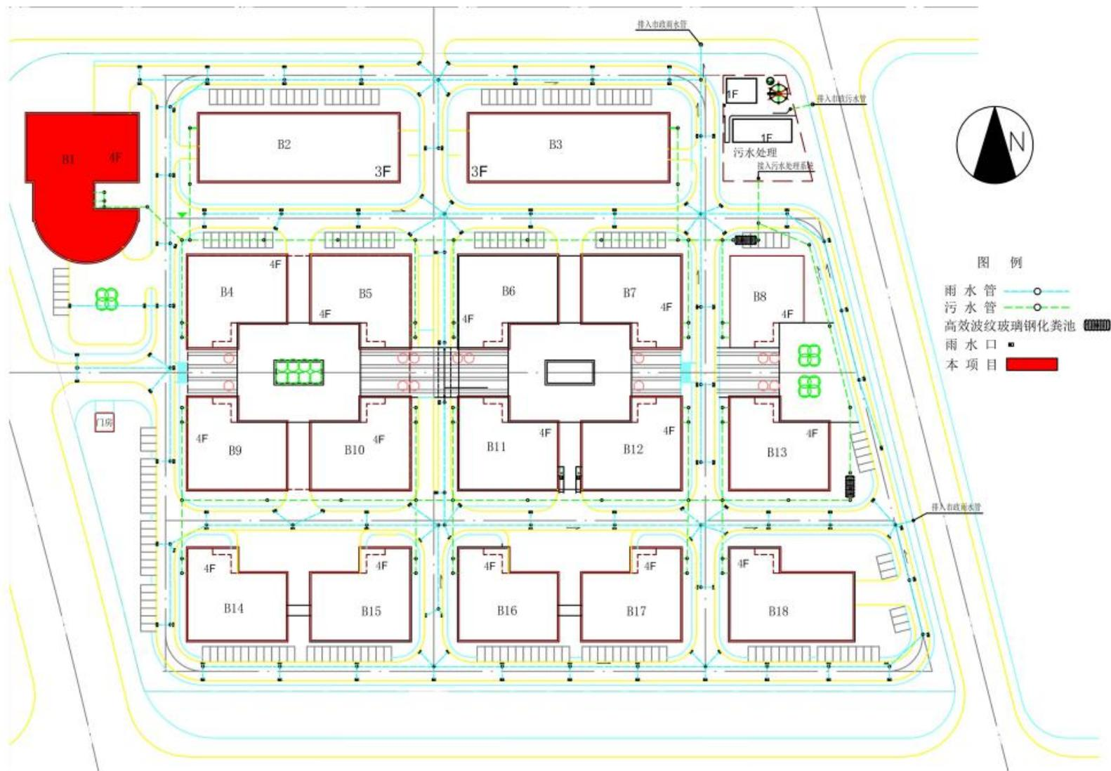
附图5 项目及园区雨污管网图
