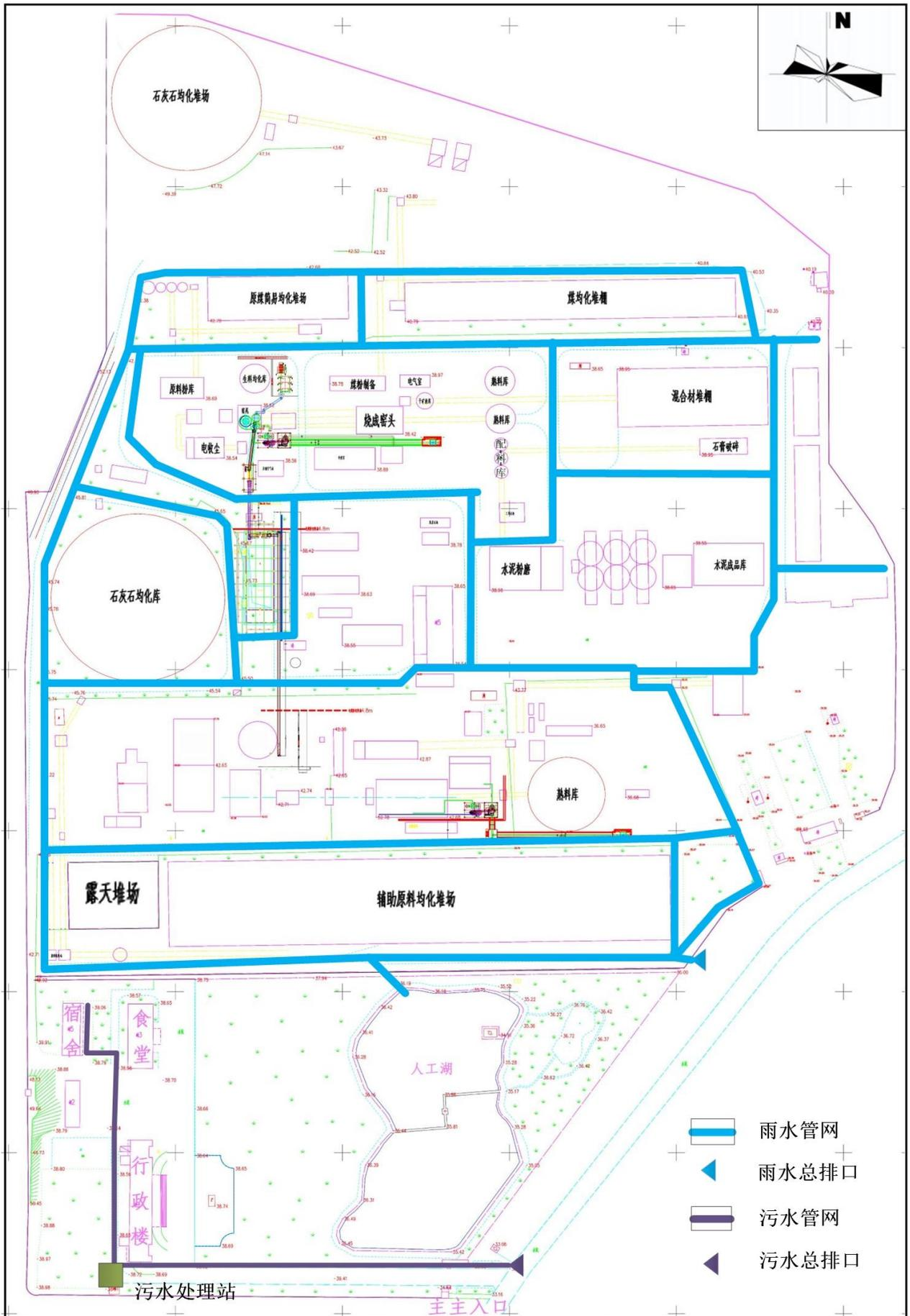
附图 6 厂区雨污管网示意图
