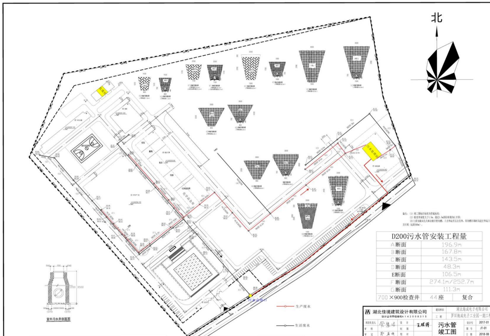
附图7 项目污水管网图
