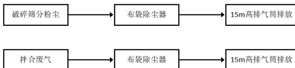
图 3-1 废气处理工艺流程图
