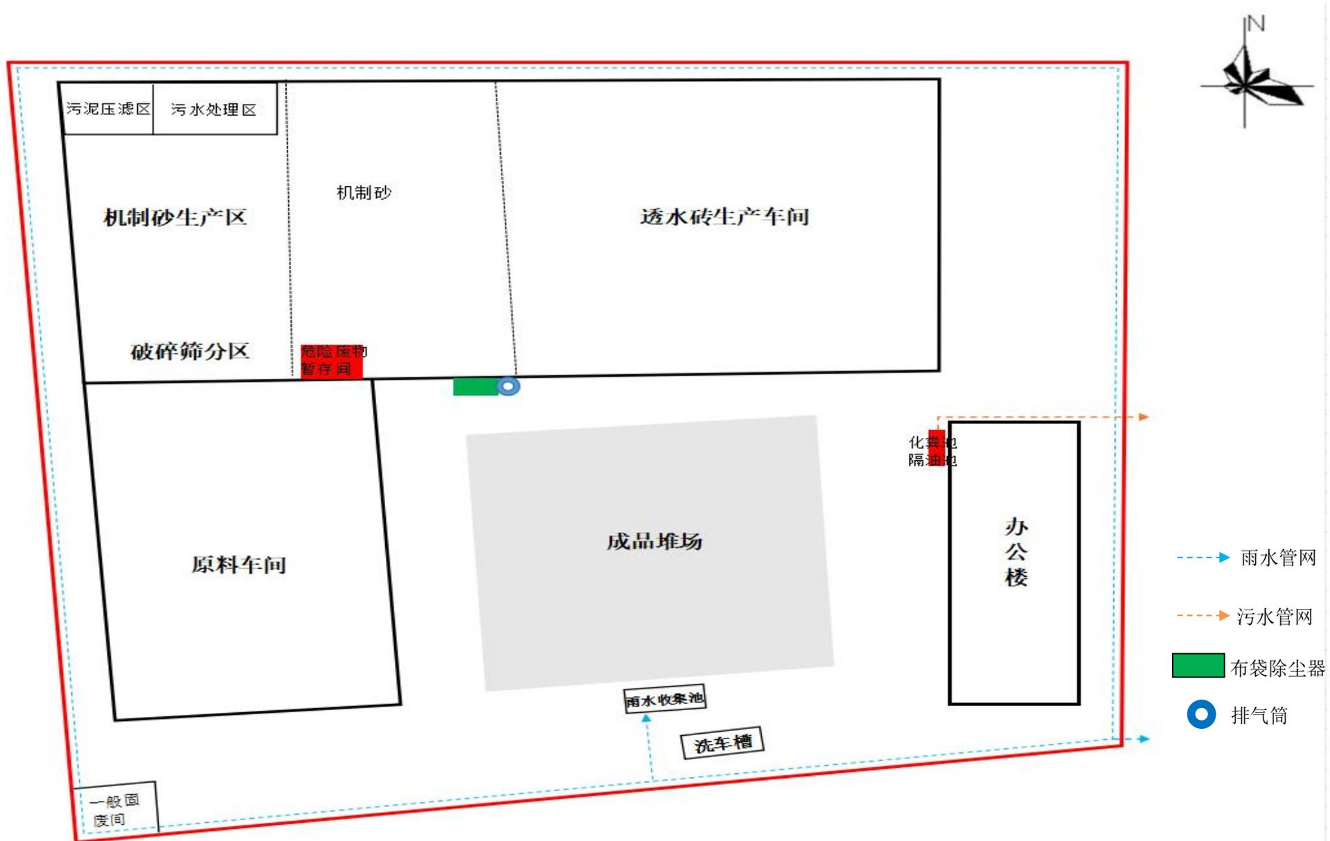
附图3 厂区平面布置图及雨污管网图
